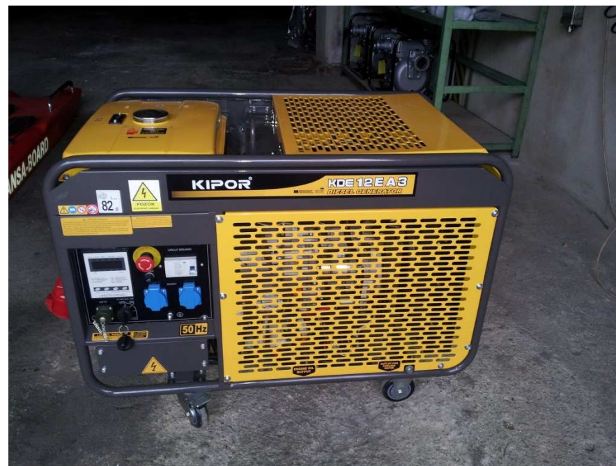
obr.č. 6: třífázová elektrocentrála
