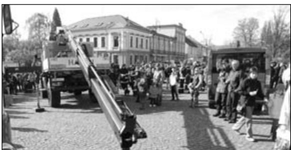
Ukázka dosahu hydraulické ruky vyprošťovacího vozidla
